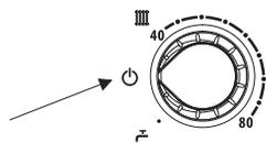
۳- شیر اصلی گاز و سپس شیر فلکه مسیرهای رفت و برگشت رادیاتورها و آب گرم مصرفی را ببندید. دقت کنید که پس از خاموش شدن دستگاه، سیستم‌های ضد یخ و ضد گریپاژ پمپ نیز از کار می‌افتند؛ بنابراین چنانچه در محل استفاده از دستگاه احتمال یخ زدگی وجود دارد، لازم است آب سیستم‌های گرمایش و آب گرم مصرفی شوفاژ را حتماً تخلیه نمایید.
