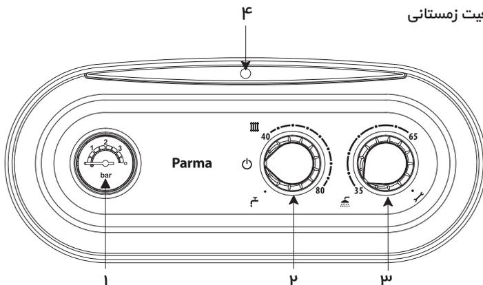
۱- نمایشگر فشار آب مدار گرمایش: فشار آب داخل دستگاه را برحسب بار نشان می‌دهد.
