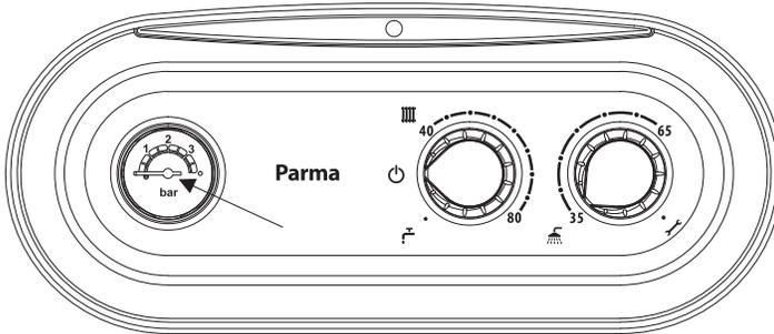
۲- دسته انتخاب وضعیت و تنظیم دمای مدار گرمایش: برای روشن و خاموش کردن دستگاه، انتخاب فصل، راه اندازی مجدد دستگاه و تنظیم دمای مدار گرمایش به کار می‌رود و می‌تواند در ۳ وضعیت (قطع موقت / راه اندازی مجدد)، (تابستانی) و (زمستانی) قرار گیرد.
