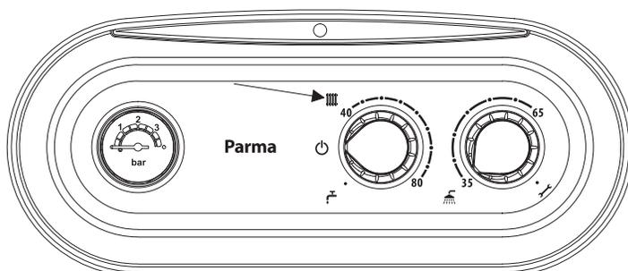
۳- **دسته تنظیم دمای آب گرم مصرفی:** برای تنظیم درجه حرارت آب گرم مصرفی به کار می‌رود. با چرخاندن دسته تنظیم در جهت حرکت عقربه‌های ساعت، دمای آب افزایش و با چرخاندن آن در خلاف جهت حرکت عقربه‌های ساعت، دمای آب کاهش می‌یابد.
