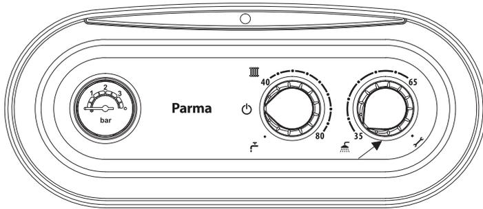
**(وضعیت Sweeper):** این وضعیت مربوط به سرویسکار بوده و به هیچ‌وجه دسته تنظیم دمای آب گرم مصرفی را در این حالت قرار ندهید.
