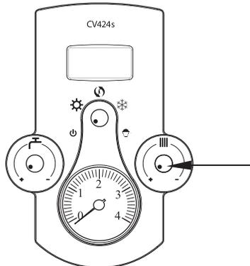
۵- **دسته تنظیم دمای آب گرم مصرفی (T):** برای تنظیم درجه حرارت آب گرم مصرفی به کار می رود. با چرخاندن دسته تنظیم در جهت حرکت عقربه های ساعت، دمای آب کاهش و با چرخاندن آن در خلاف جهت حرکت عقربه های ساعت، دمای آب افزایش می یابد.
