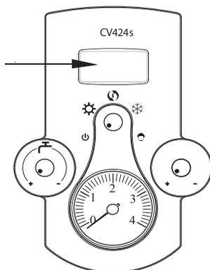
۳- **دسته انتخاب وضعیت:** برای روشن و خاموش کردن دستگاه، انتخاب فصل، راه‌اندازی مجدد دستگاه و Sweeper به کار می‌رود و می‌تواند در پنج وضعیت (قطع دستگاه)، (تابستانی)، (منوی اطلاعات / راه‌اندازی مجدد (Reset))، (زمستانی) و (Sweeper) قرار گیرد.
