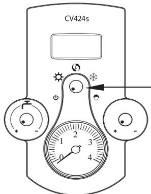
(وضعیت قطع دستگاه): برای خاموش کردن دستگاه به کار می‌رود؛ در این حالت سیستم ضد گریناژ و ضد یخ زدگی فعال است.
